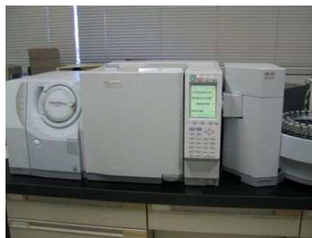
ガスクロマトグラフ質量分析計 (有機物質の分析)
