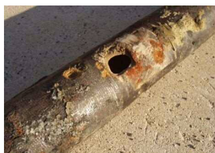
土壌の腐食性や、管外面の被覆の有無等が老朽化の進行に影響します。
