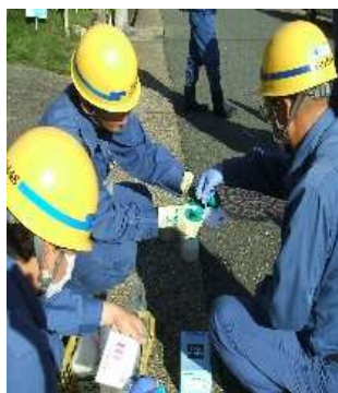
下水管路上での簡易試験 (有害物質の有無の確認)
