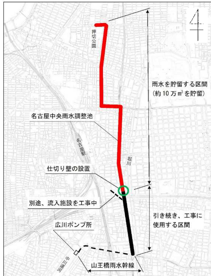
図4 仕切り壁設置により確保する雨水貯留区間
